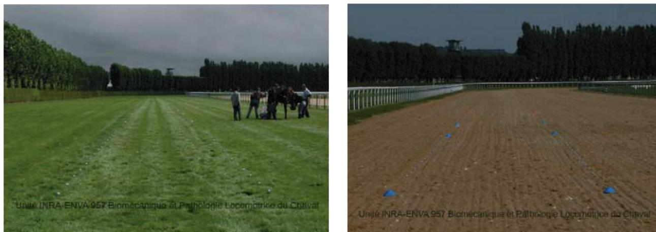
**Figure 12** : Pistes de courses de l'hippodrome de Deauville-la-Touques. A gauche : piste en gazon ; à droite : PSF (piste en sable fibré-huilé). Un couloir de 70 mètres de long et de 2,9 mètres de large a été délimité sur une ligne droite de chacune des pistes. Vers la mi-longueur du couloir (ici au premier plan sur les photos), des paires de marqueurs cinématiques réfléchissants ont été fixées dans le sol tous les mètres afin de calibrer une zone de 14 mètres de long.
