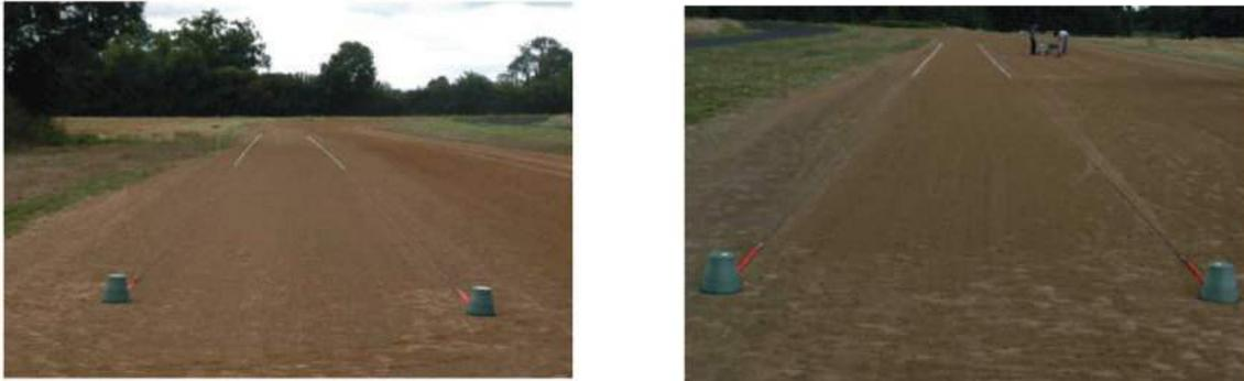
**Figure 3** : Piste en terre testée au Haras de Canteloup : à gauche, segment de piste laissée brute ; à droite : segment de piste fraîchement hersée.
